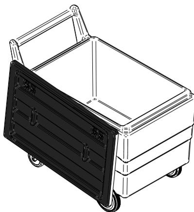
Con la tapa quitada, colocar el carrito debajo del silo. Comprobar que el carro hace tope con el fondo. Las ruedas delanteras tocarán con un tubo como se muestra en la imagen.
