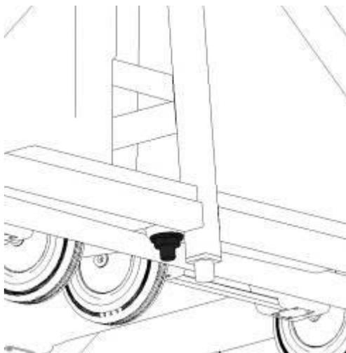
Inserire a pressione la parte con il gomito sul collegamento della parte inferiore del silo. L'altra parte dovrà essere collegata a uno scarico esterno.
